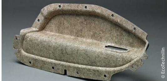
Utilisé dans les pièces intérieures de certains véhicules pour renforcer les plastiques, le chanvre est devenu une fibre référente au niveau mondial grâce à ses caractéristiques techniques.
